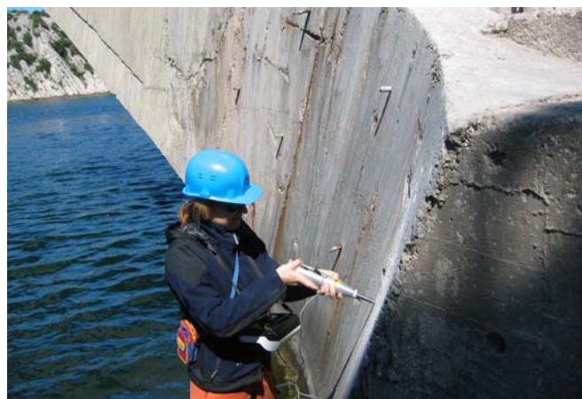
Ispitivanje sklerometrom na Šibenskom mostu
