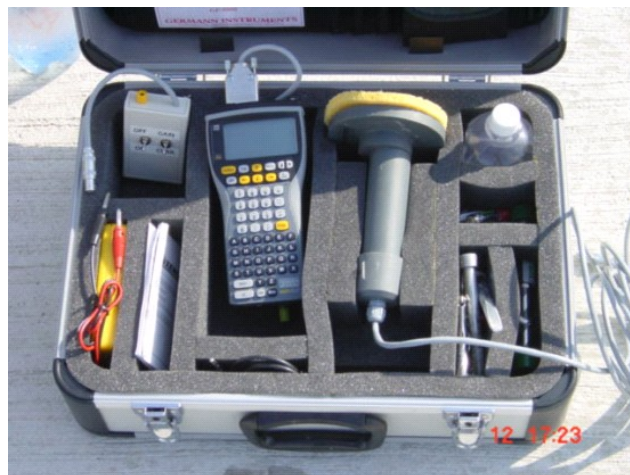
Uređaj za terensko ispitivanje stanja armature
