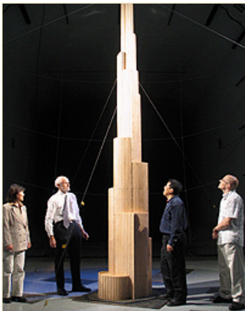
Model zgrade izrađen u mjerilu 1:500 za ispitivanje u tunelu
