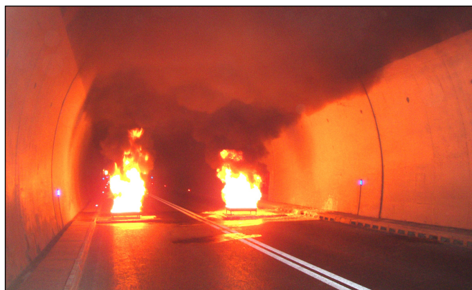
Slika 3. Požarno ispitivanje u tunelu Mala Kapela
