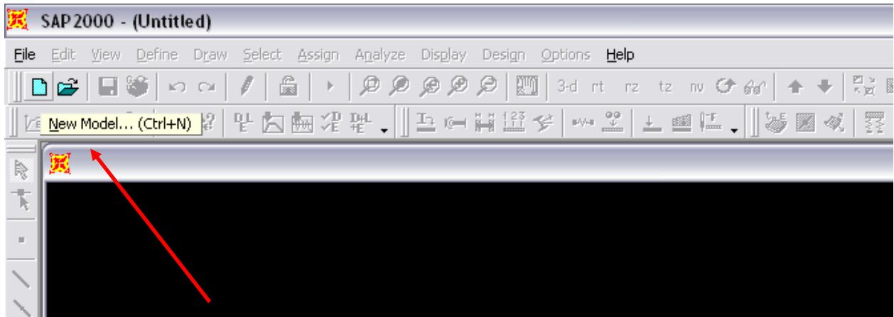
prilikom kreiranja NOVOG modela programski paket nudi inačice nekih standardnih konstrukcija, ako odaberemo neku od predloženih konstrukcija program će sam odabrati neke standardne presjeke.
