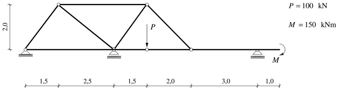
2. Primjenom metode sila izračunajte kut zaokreta osi neposredno desno od točke A.
