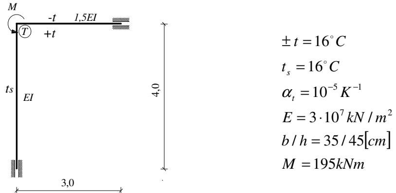
**T1. (20)** Za zadani statički neodređeni sistem skicirajte jedan osnovni sistem za proračun metodom sila i objasnite geometrijsko/kinematičko značenje pripadnih uvjeta kompatibilnosti.
