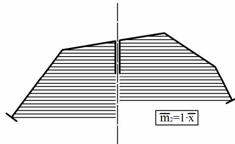
$$\delta_{23}^* = \int_i^j \frac{\bar{m}_2 \bar{m}_3}{EI(s)} ds = \int_i^j \frac{1 \cdot \bar{x} \cdot 1}{EI(s)} ds = \int_i^j \frac{\bar{x}}{EI(s)} ds = \int_i^j \frac{x - x_c}{EI(s)} ds = \int_i^j \frac{x}{EI(s)} ds - \int_i^j \frac{x_c}{EI(s)} ds = \int_i^j \frac{x}{EI(s)} ds - x_c \int_i^j \frac{ds}{EI(s)} = 0$$
