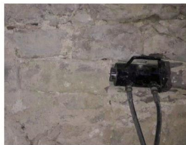
Slika 29. Priprema ispitivanja posmične čvrstoće zida na mjestu S-8
