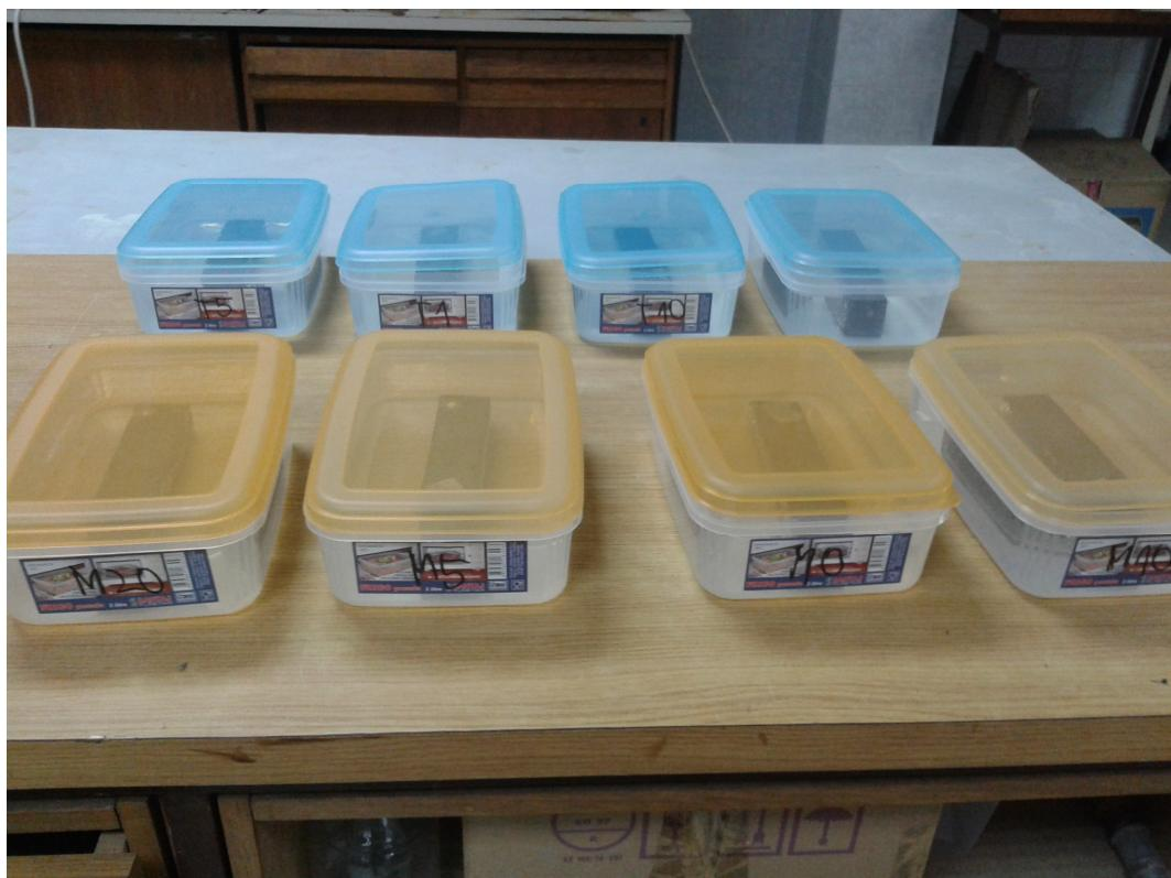
Slika 59 Monolitni uzorci morta s ugrađenim pepelom potopljeni u demineraliziranoj vodi za provđebu „tank leaching testa“
