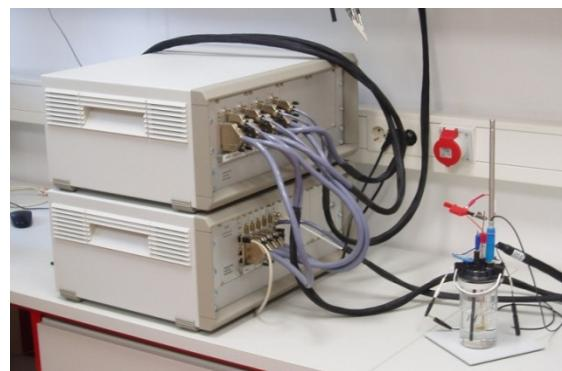
**Slika 64 Sustav za elektrokemijska ispitivanja koroziske otpornosti**
