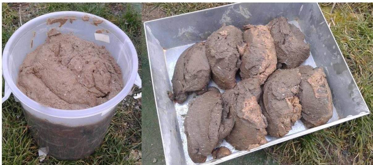
**Slika 3 Dehidriran i stabiliziran mulj s UPOV Varaždin za potrebe projekta „RESCUE“ dopreman je u plastičnim kantama i potom pripremljen za sušenje na temperaturi 105°C**
