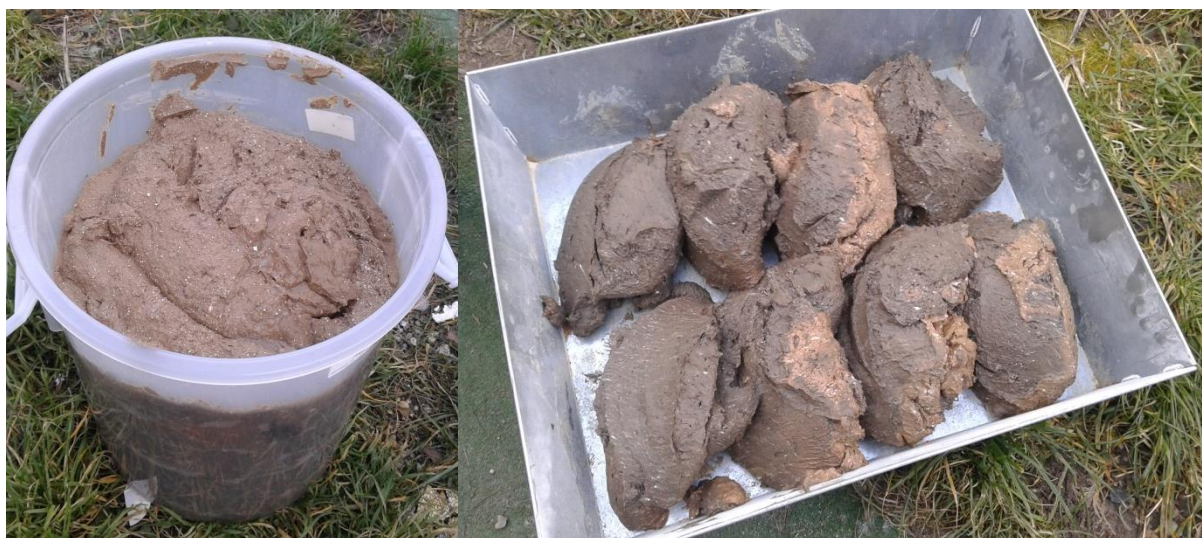
Slika 2 Dehidriran i stabiliziran mulj s UPOV Varaždin za potrebe projekta „RESCUE“ dopreman je u plastičnim kantama i potom pripremljen za sušenje na temperaturi 105°C
