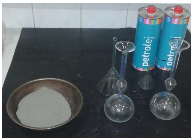
Slika 4 Pribor korišten u postupku određivanja gustoće pepela (i cementa) prema ASTM C-188
