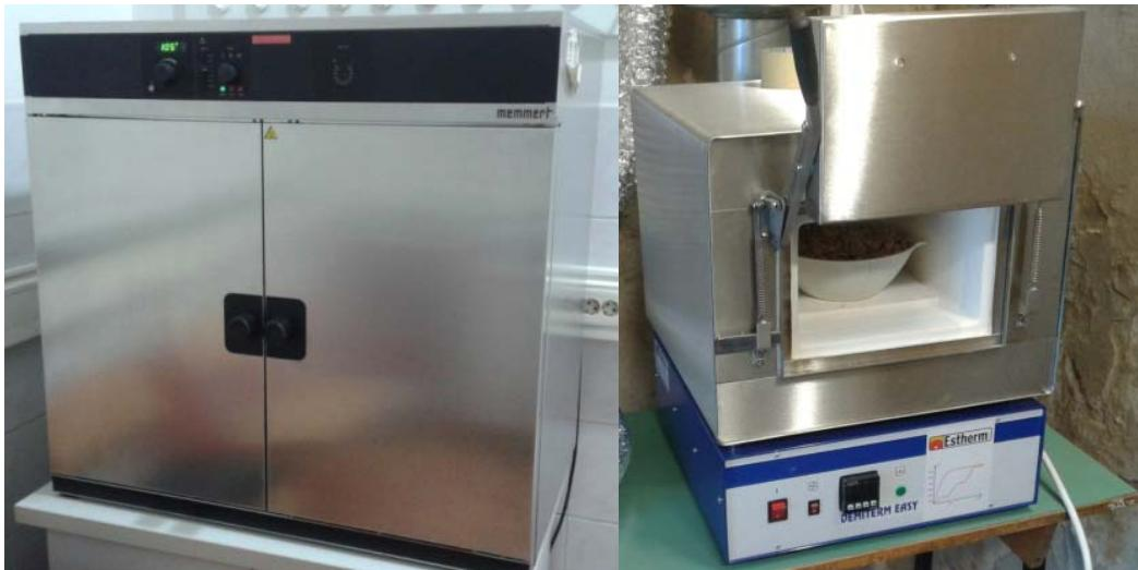
Slika 1 Korištena laboratorijska oprema u procesu sušenja i spaljivanja mulja (sušionik i električna peć)
