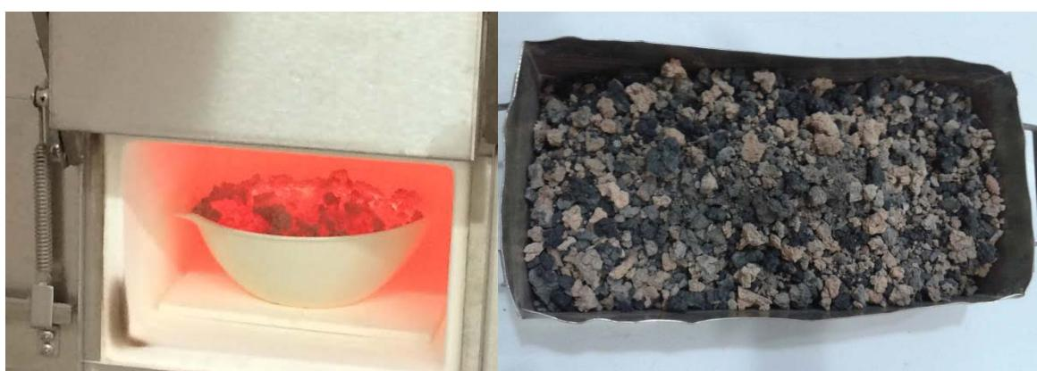
Slika 2 Užareni mulj tijekom spaljivanja i granule stvrdnutog pepela nakon spaljivanja na  $800^{\circ}\text{C}$  (istraživanje u sklopu projekta „RESCUE“ na Građevinskom fakultetu u Zagrebu s muljem s UPOV Karlovac)
