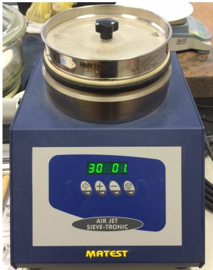
Slika 5 Treskalica za praškaste materijale s efektom vakuma
