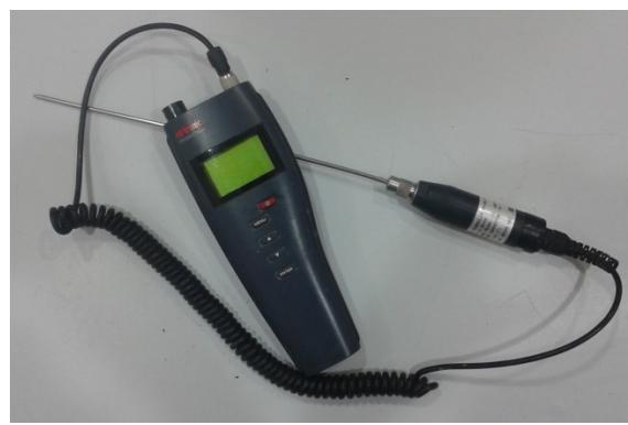
Slika 5 Digitalni ubodni termometar
