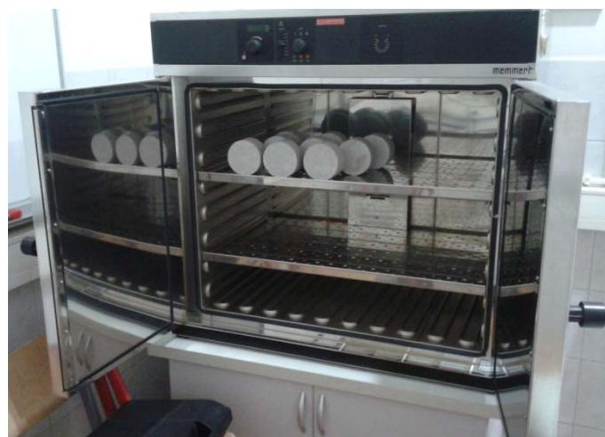
Slika 15 Sušenje uzorka u sušioniku
