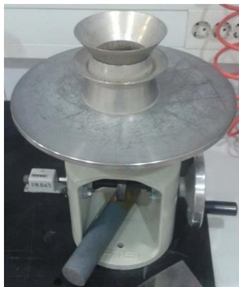
Slika 6 Aparatura za određivanje konzistencije
