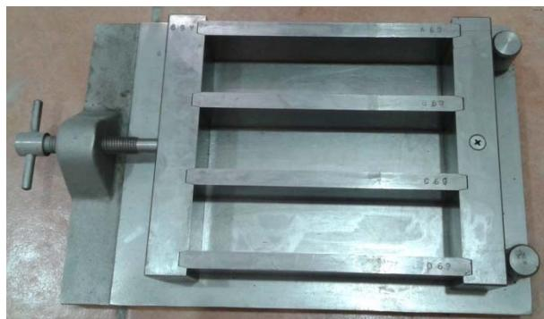
**Slika 2 Čelični kalup standardiziranih dimenzija za ugradnju cementnog morta za ispitivanja čvrstoće na savijanje i tlačne čvrstoće**
