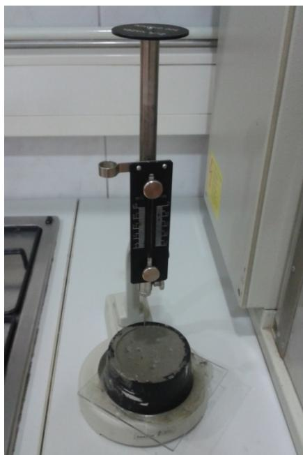
Slika 9 Određivanje vremena vezivanja Vicat-ovim aparatom
