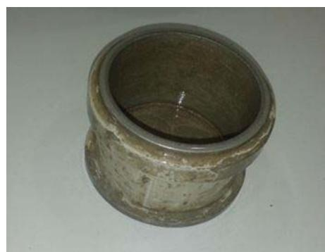
Slika 4 Kalup poznatog volumena  $1,0 \text{ dm}^3$  korišten u postupku određivanja gustoće svježeg morta
