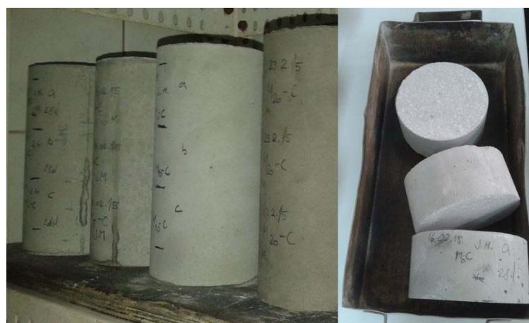
Slika 14 Valjci u vlažnoj komori i ispljeni valjci (svaki u 3 uzorka)
