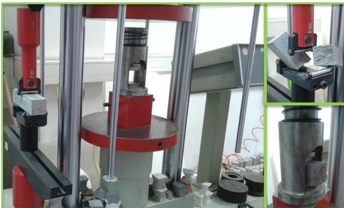
Slika 10 Preša za savijanje i tlačenje
