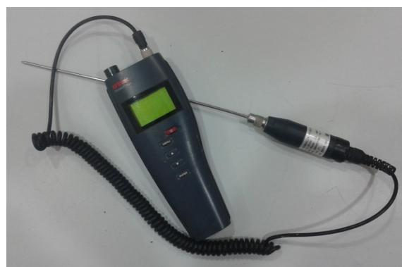
Slika 3 Digitalni ubodni termometar
