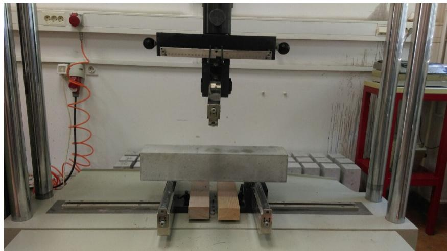
Slika 7 Preša za ispitivanje čvrstoće na savijanje na uzorcima betona
