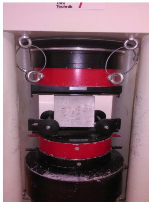
Slika 6 Preša za tlačenje uzorka betona
