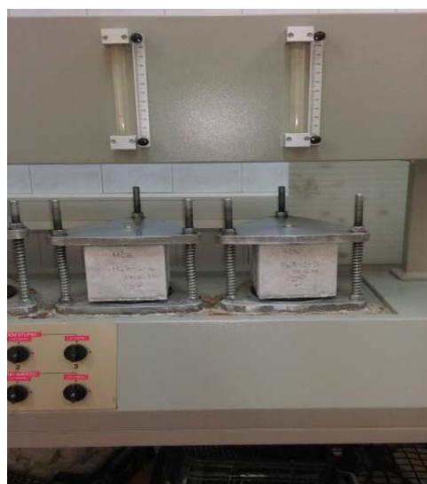
Slika 8 Stroj za utiskivanje vode pod tlakom u uzorce betona
