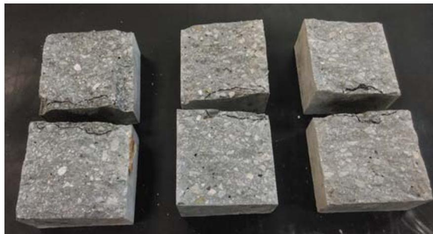
Slika 9 Uzorci betona na kojima se ispitivala vodonepropusnost
