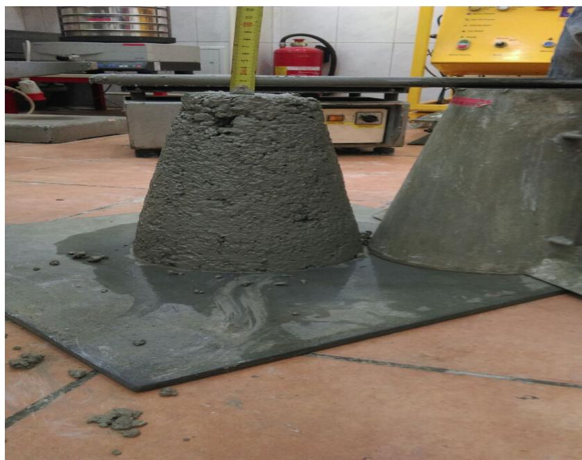
Slika 4 Određivanje konzistencije betona slijeganjem
